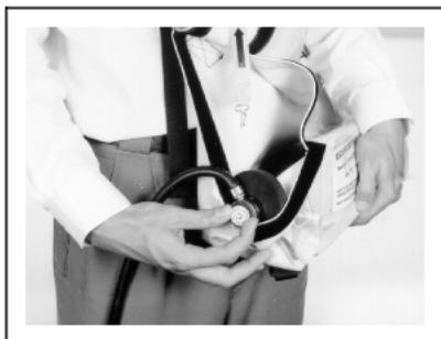
5. Si aún no se escucha el sonido de la salida del aire, tirar del disco blanco de emergencia situado en el reductor/válvula de la botella.
