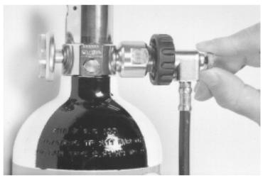
7. Feche a válvula de abastecimento do compressor, sangre a pressão do tubo de abastecimento, desligue o adaptador de carregamento do cilindro e coloque a tampa do pó do adaptador de carregamento.
