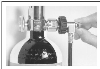
7. Cerrar la válvula de suministro del compresor, quitar la presión de la manguera de suministro, desconectar de la botella el adaptador del cargador y colocar la tapa protectora de polvo en el adaptador.
