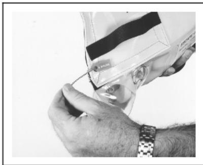
6. Cerrar la solapa de la bolsa y colocar las etiquetas anti-manipulación.
