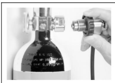
3. Applicare il raccordo per la ricarica alla valvola della bombola.
