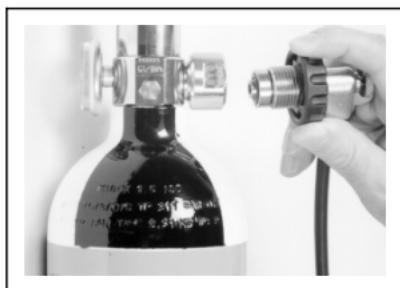
3. Aplique o dispositivo de ligação de carregamento de 200 bar tipo G5/8 ao adaptador de carregamento.
