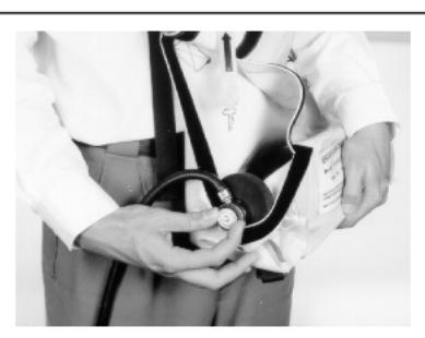
5. Se ainda não houver qualquer som, aceda à válvula do redutor/cilindro e puxe o disco branco de controlo.
