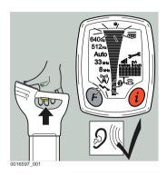
Turning on and off the DD220/DD230
