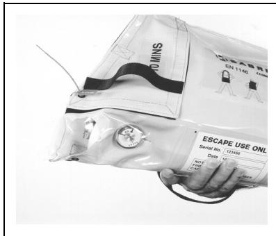
1. Kontrollér at manometerets viser er i det grønne felt, hvilket viser at flasken er tilstrækkelig fyldt.
