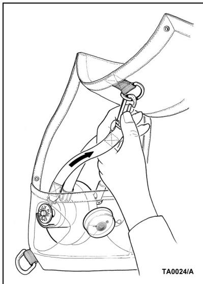
5. Monter aktiveringsstroppen til tennnålen.
