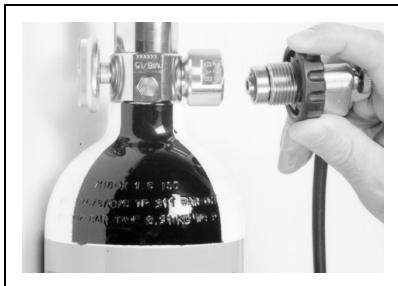
3. Skru på G5/8 kopling for 200 bar til påfyllingsadapteren.
