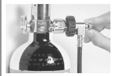
7. Stäng kompressorns tillopps-ventil, lufta av trycket från tillopplsslansen, koppla bort fyllnings-adaptern från flaskan och sätt tillbaka fyllningsadapterns dammskydd.
