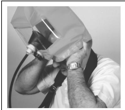
8. Hold hetten etter halstetningen over hodet (issen), og trekk hetten ned over hodet til tetningen er rundt halsen. Kontroller at ikke klesplagg eller hår sitter fast i halstetningen.
