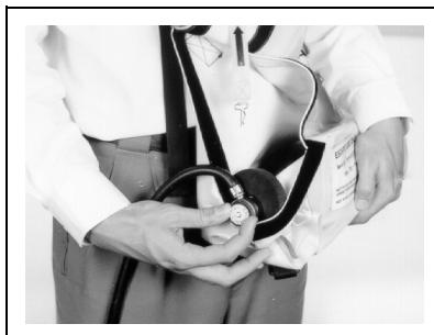
5. Hvis det fremdeles ikke er noe lyd, trekk i den hvite overkopplingsskiven på reduksjons-/flaskeventilen.
