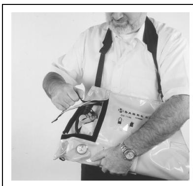
2. Hold i bagen og trekk i klaffen for å trekke ut tenn-nålen. Lytt etter luftstrøm inn i hetten.
