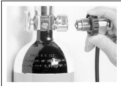
3. Montera en 200 bar G5/8 fyllningsanslutning på fyllnings-adaptern.
